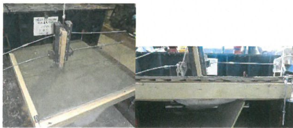
写真7 ②仕様ラスモルタル ミサイルE
