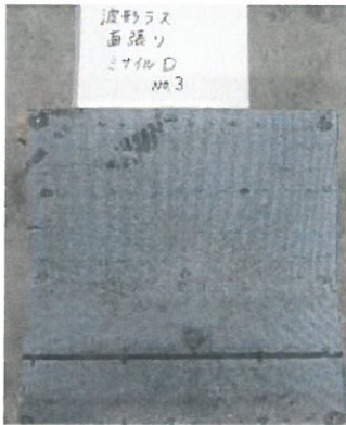
ミサイルD 衝撃後の改質アスファルト表面 写真2 ラスモルタル外壁ミサイルD 試験後の状況
