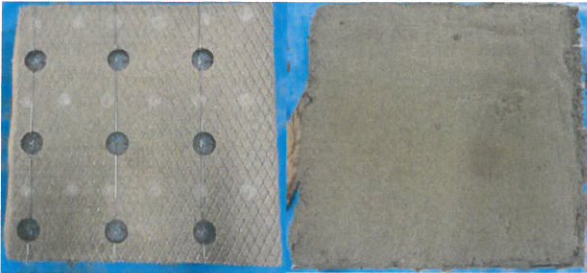
写真5 カ骨付きコブラス 写真6 モルタル塗り付け
