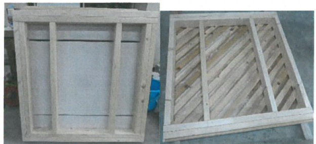
ALCサイディング 斜め通気胴縁ラスモルタル下地 写真12 910mm角サイズ外壁試験体裏面
