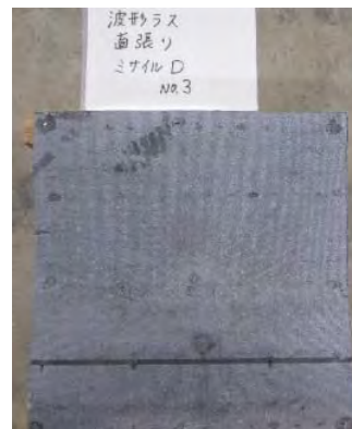
ミサイルD 衝撃後の改質アスファルト表面
