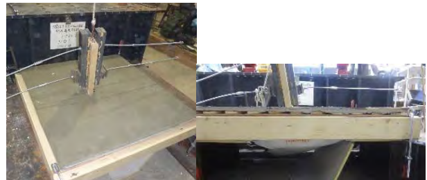
写真 19 ②仕様ラスモルタル ミサイルE
